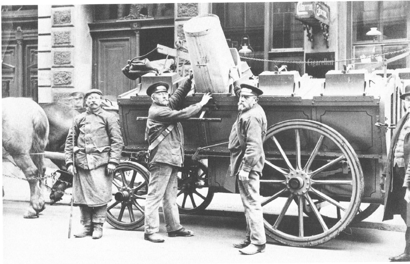
Abb. 120: Colonia-System als Tonnenumlersystem. Erste Ausführungsform der Schüttung. Probetrieb in Magdeburg 1910.
