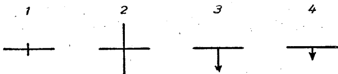
Εἰκ. 3 Σημεῖα δεικνύοντα τὴν κλίσειν τῶν στρωμάτων 1 = στρώματα κατακόρυφα 2 = στρώματα ὀριζόντια 3 = στρώματα με μικρὰν κλίσειν 4 = στρώματα με μερᾶλλον κλίσειν
