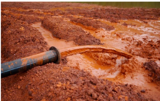
Εικόνα 5: Σημείο συσσώρευσης «κόκκινης λάσπης» (red mud), του υπολείμματος που παράγεται ύστερα από την παραγωγή της αλούμινας ( Al_2O_3 ) από τον βωξίτη. Εμφανίζει, μεταξύ άλλων, σύσταση πλούσια σε οξείδια του σιδήρου και του τιτανίου 1
