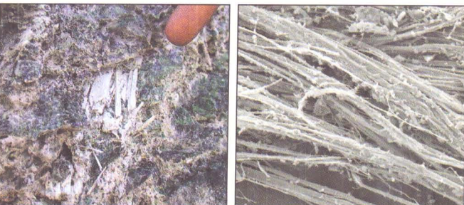
Ίνες αμιάντου σε πέτρωμα σερπεντινίτη αριστερά και μεγεθυμένες με ηλεκτρονικό μικροσκόπιο δεξιά.
