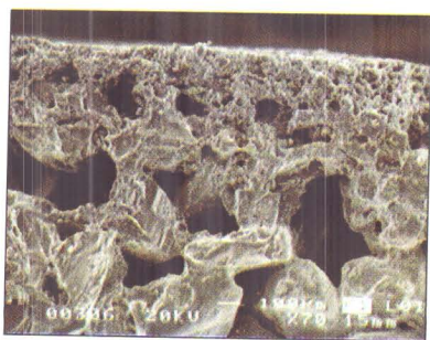
Δομή βαθμωτού πορώδους κεραμικού φίλτρου αισθήλης
