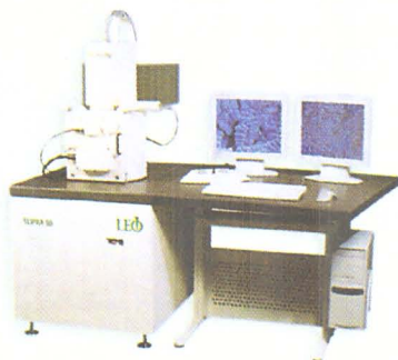
Ηλεκτρονικό Μικροσκόπιο Σάρωσης LEO Ηλεκτρονικά Μικροσκόπια TEM και SEM, σε συνδυασμό και με στοιχειακό Αναλυτή Röntgen
