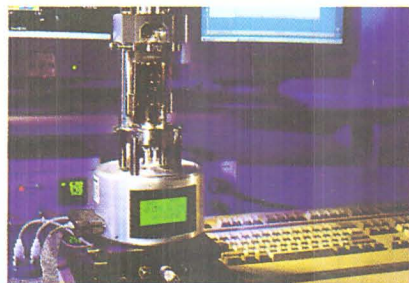
Μικροσκόπιο Ατομικής Δύναμης Veeco Κάλυψη όλων των τεχνικών: AFM, LFM, MFM, STM, EFM, SCM, SThM, ECSTM, ECAFM, κλπ.
