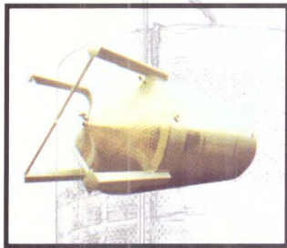
Δεξαμενή με θερμαινόμενο πυθμένα χωρητικότητας 60 τόνων
