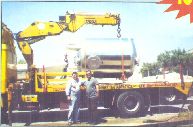
ΚΑΤΑΣΚΕΥΗ ΑΝΟΞΕΙΔΩΤΟΥ ΦΙΛΤΡΟΥ ΓΙΑ COCA COLA ΘΕΣΣΑΛΟΝΙΚΗΣ
