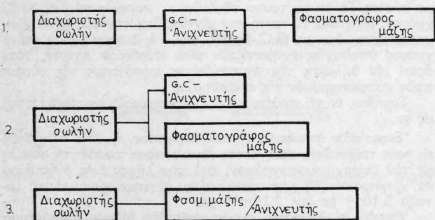
Σχῆμα 5. Σχηματικὴ παράστασις τῶν βασικῶν δυνατοτήτων διατάξεως τῶν G.C. καὶ Μ.Σ. κατὰ τὴν ἀπ' εὐθείας σύζευξιν.
