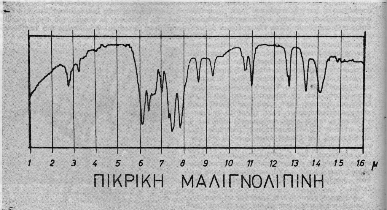
Εικόνα 55. Υπερόυθρον φάσμα πικρικής μαλιγνολιπίνης, περιέχον πιθανώς και προσμίξεις. Αναχρονστάλλωσις ἐκ διοξάνης - βενζολίου. (Καλλίστρατος, Kahlert). Infra - red spectrum of malignolipin picrate.
