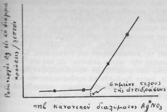
Σχῆμα 1. Ἀντίδρασις καθιζήσεως κατὰ τὴν ὁποίαν τὸ προστιθέμενον ἀντιδραστήριον περιέχει τὸν ραδιενεργὸν δείκτην.
