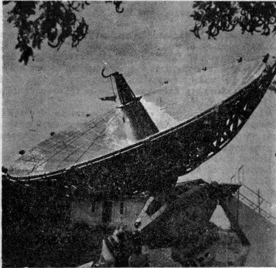
Εἰς Νότιον Ἀφρικὴν ὁ καθηγητὴς Α. Guilemonat, ἔσχεδιά- σε παραβολικὸν ἀνακλαστήρα διαμέτρου 8,50 μέτρων καὶ βάρους 40 τόννων, δυνάμενον νὰ δημιουργήσῃ θερμοκρασί- αν 3000 C. Εἰς τὸν ἡλιακὸν αὐτὸν Κλίβανον ἐπετεύχθη σύνθεσις νιτρικοῦ ὀξέος ἀπὸ τὸν ἀέρα παρουσίᾳ ὕδατος.
