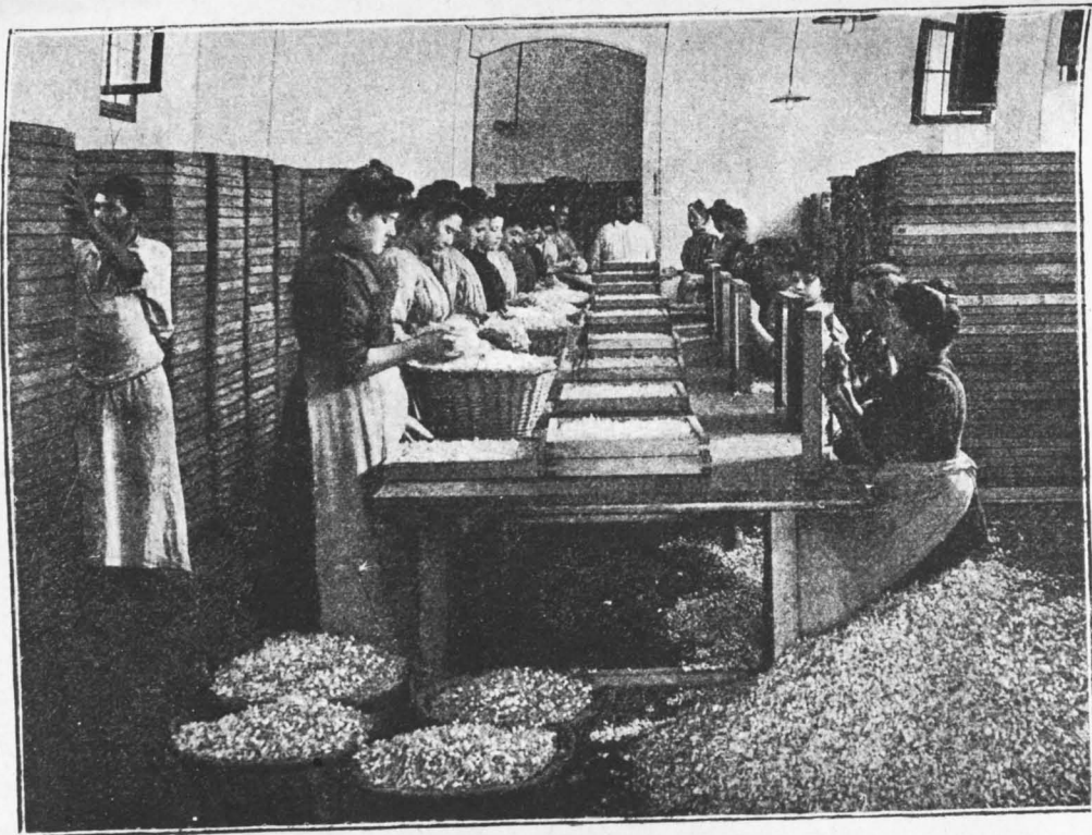
Εἰγ. 10.—'Αποροόφησις ὑπὸ λίπους ἐν ψυχρῷ. Ἄριστερά: Ἐνθῆσις τῶν ἀνθέων (enfleurage).—Δεξιά: Ἀποχωρισμὸς τῶν ἀνθέων (défleurage). Παρὰ τοὺς τοίχους: Ἐπάλληλος τοποθέτησις τῶν πινακιδίων.
