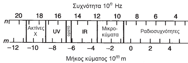
Σχ. 1.3 Οι διάφορες περιοχές του ηλεκτρομαγνητικού φάσματος με τις καθοριστικές συχνότητες και μήκη κύματος σχεδιασμένα σε λογαριθμική κλίμακα.
