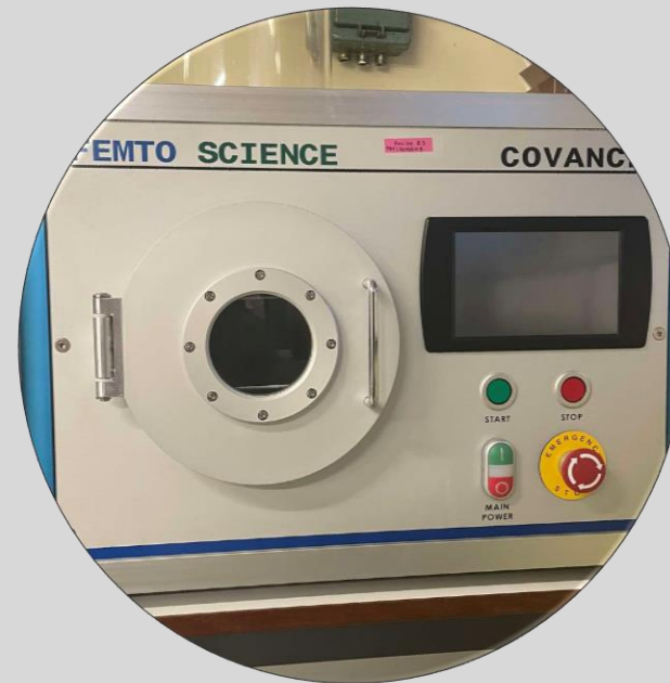
Αντιδραστήρας Πλάσματος Χαμηλής Πίεσης
