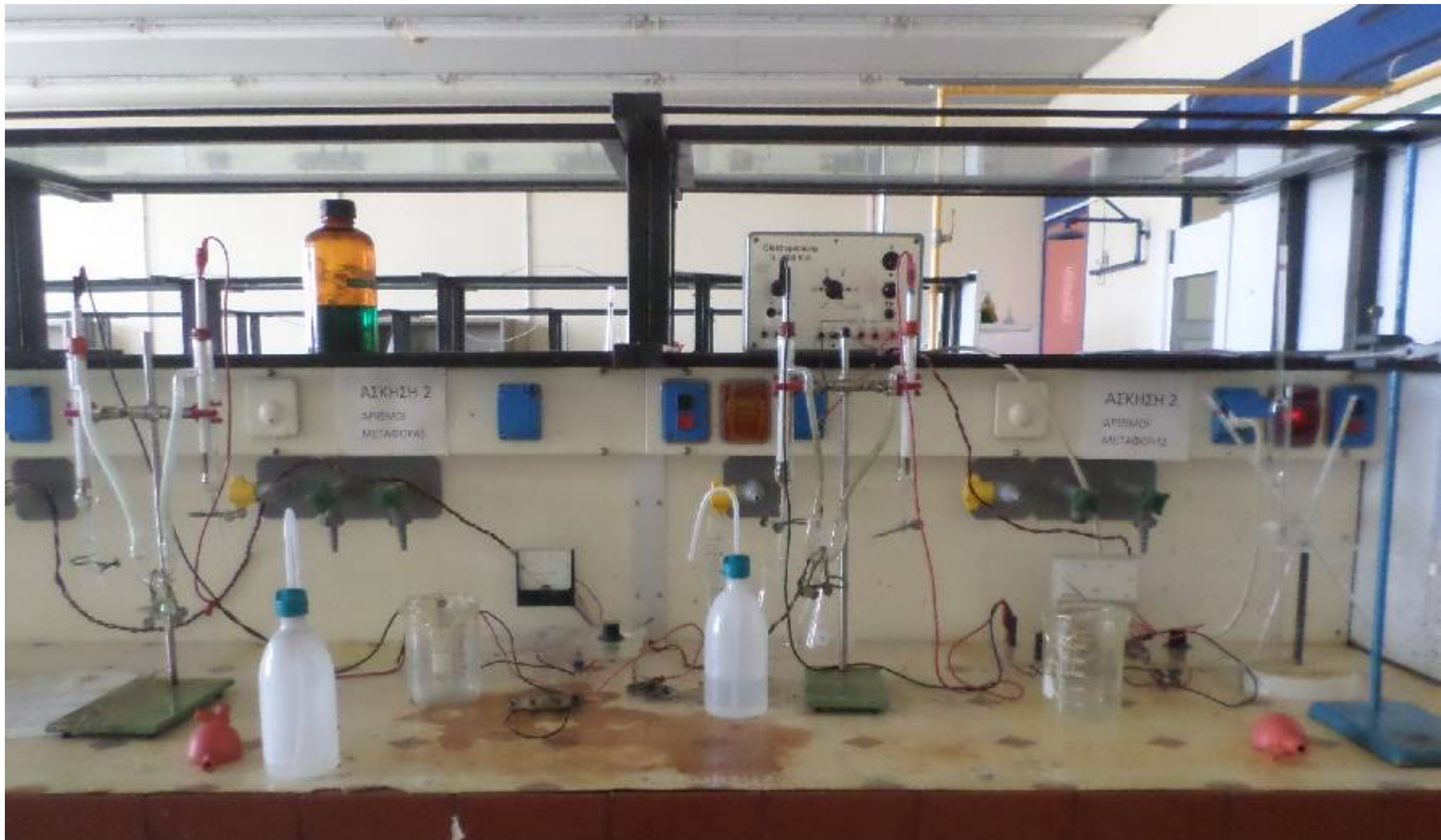
Διάταξη μετρήσεως αριθμού μεταφοράς φορτίου σε ηλεκτρολύτες
