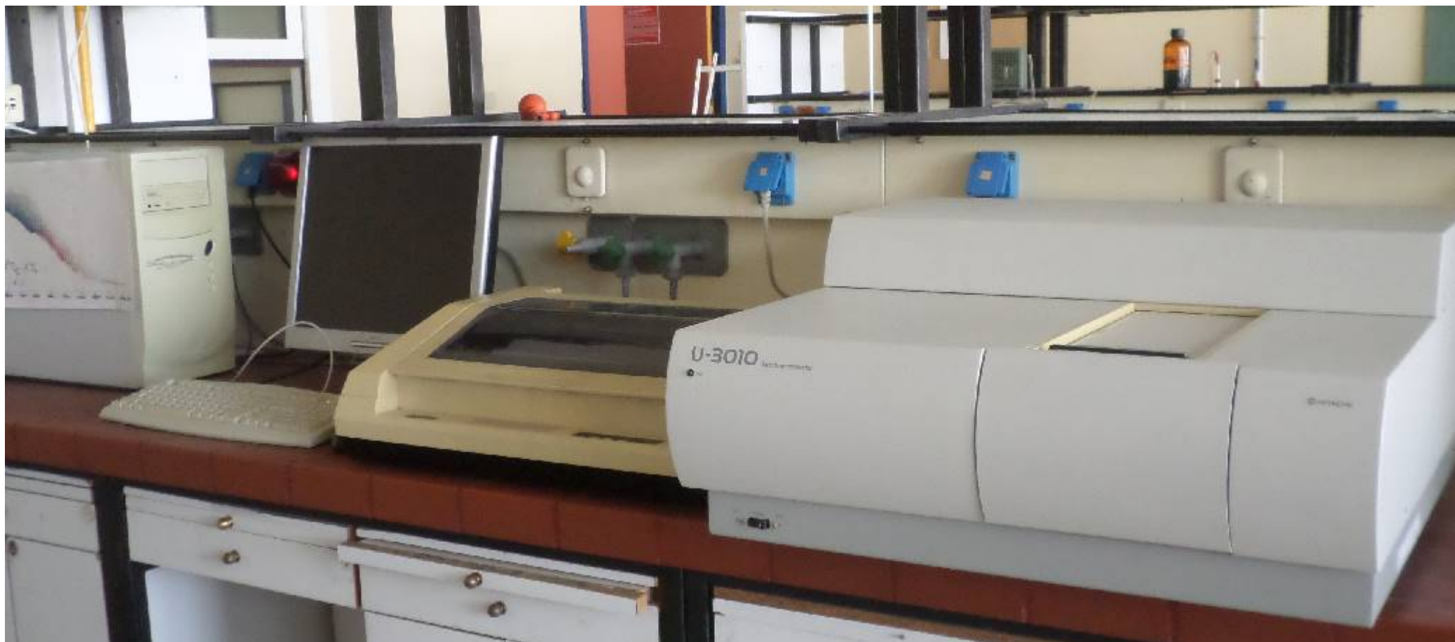
Φασματοφωτόμετρο ορατού υψηλής διακριτικής ικανότητας
