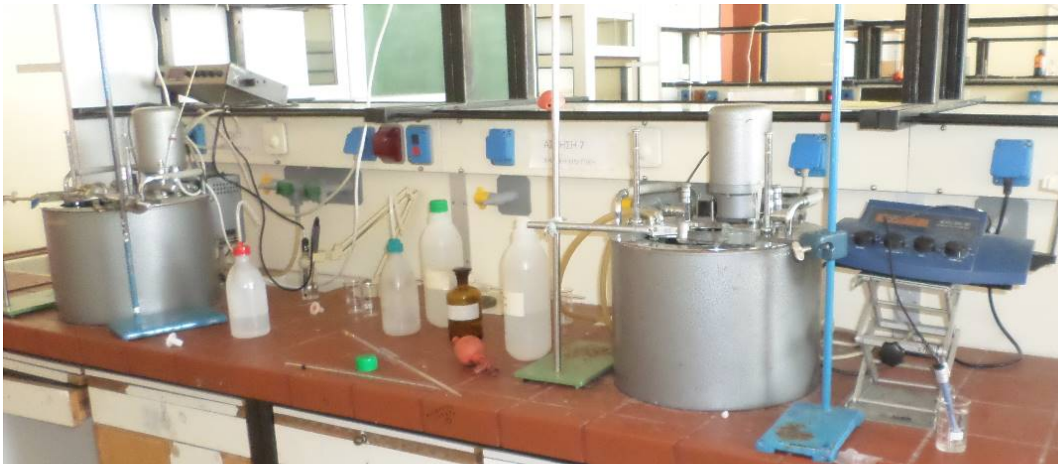
Διάταξη μετρήσεως ταχύτητας αντιδράσεων με αγωγιμομετρία
