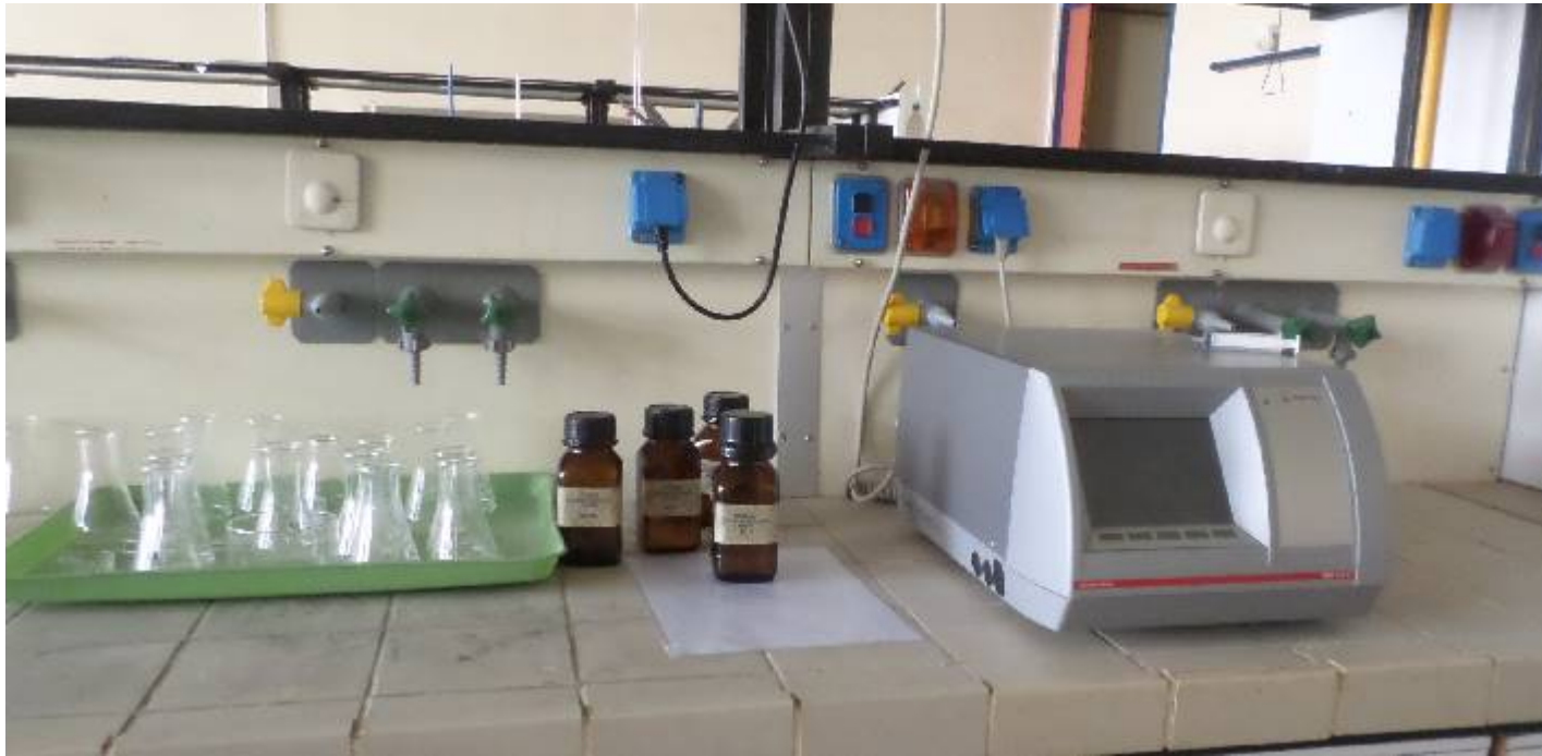
Συσκευή μετρήσεως πυκνότητας υγρών
